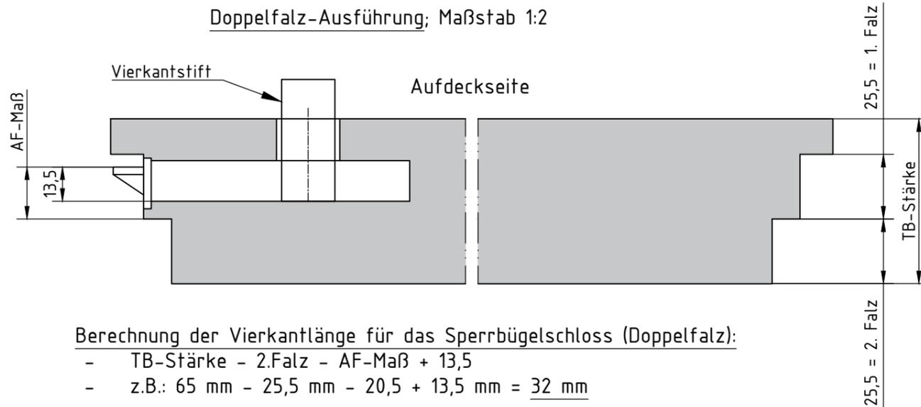
Berechnung der Vierkantlänge für das Sperrbügelschloss (Doppelfalz):
