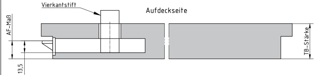
Berechnung der Vierkantlänge für das Sperrbügelschloss (gefälzt):
