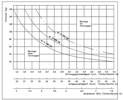
! In bestimmten Anwendungsfällen muß zusätzlich ein Türstopper angebracht werden. (siehe Diagramm)
