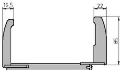
GARANT-Renovierungszarge für dünne Wände, Typ B (Fertigung nach Aufmaß, volle 5 mm Schritte), Bekleidungsbreite 85 mm, Futter und bombierte Bekleidung abgerundet und auf Gehrung, fertig oberflächenbehandelt, Wandstärkenausgleich -0/+20 mm, Kartonverpackung.
