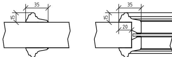
Maße gelten für gefälzte Elemente, bei stumpfen Elementen müssen seitlich und oben 13mm abgezogen werden
