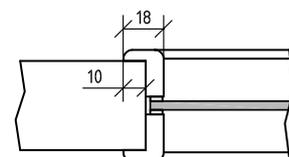
Maße gelten für gefälzte Elemente, bei stumpfen Elementen müssen seitlich und oben 13mm abgezogen werden
