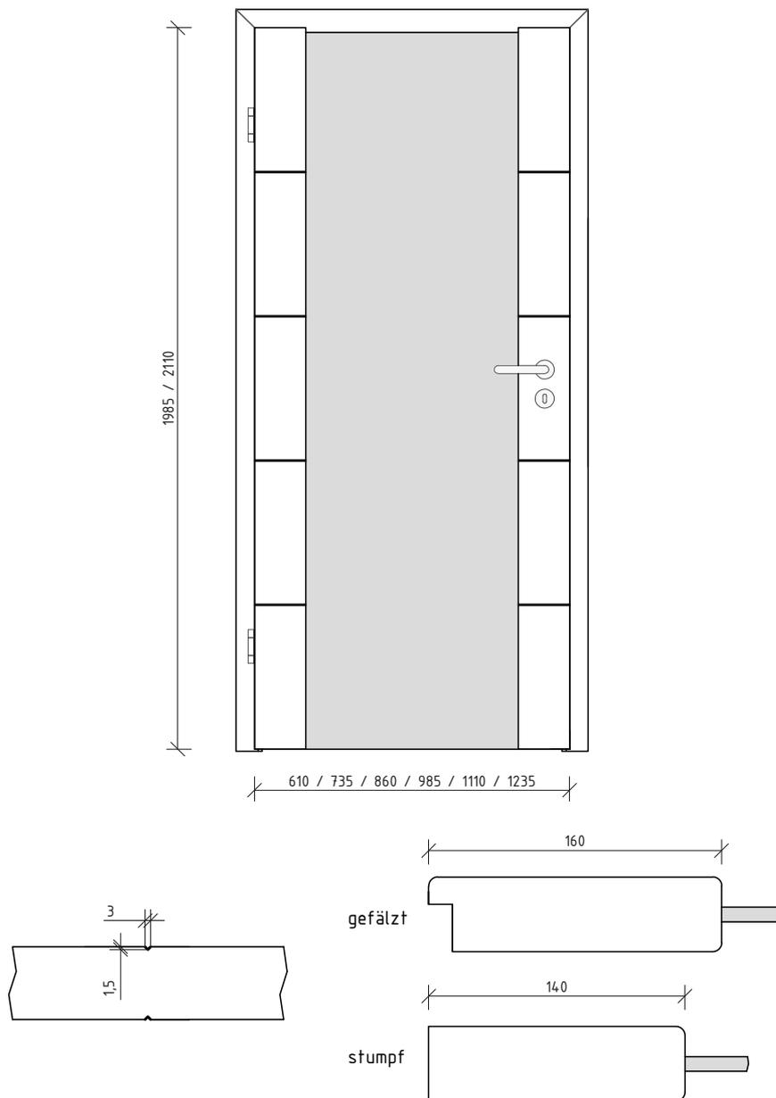
Maße gelten für gefälzte Elemente, bei stumpfen Elementen müssen seitlich und oben 13mm abgezogen werden
