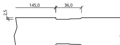
Maße gelten für gefälzte Elemente, bei stumpfen Elementen müssen seitlich und oben 13mm abgezogen werden
