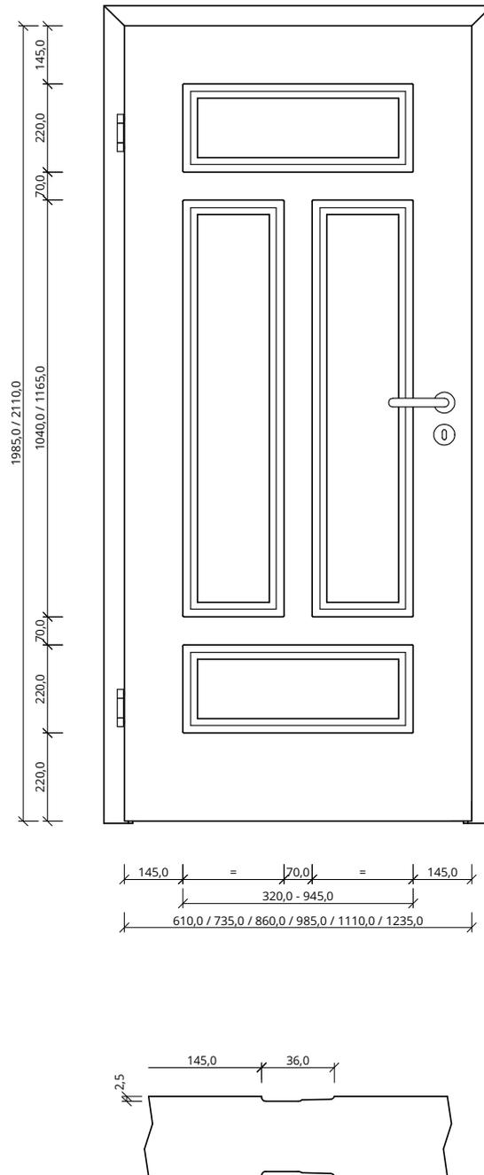
Maße gelten für gefälzte Elemente, bei stumpfen Elementen müssen seitlich und oben 13mm abgezogen werden
