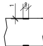
Maße gelten für gefälzte Elemente, bei stumpfen Elementen müssen seitlich und oben 13mm abgezogen werden
