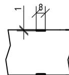
Maße gelten für gefälzte Elemente, bei stumpfen Elementen müssen seitlich und oben 13mm abgezogen werden
