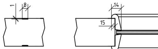
Maße gelten für gefälzte Elemente, bei stumpfen Elementen müssen seitlich und oben 13mm abgezogen werden
