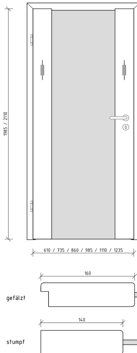
Türblatt Maße gelten für gefälzte Elemente, bei stumpfen Elementen müssen seitlich und oben 13mm abgezogen werden
