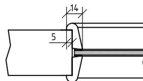
Maße gelten für gefälzte Elemente, bei stumpfen Elementen müssen seitlich und oben 13mm abgezogen werden
