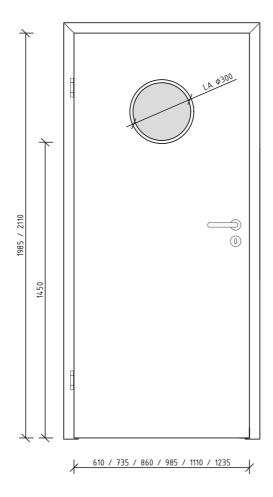
Maße gelten für gefälzte Elemente, bei stumpfen Elementen müssen seitlich und oben 13mm abgezogen werden 0287-PS\_Standard\_TB-LA12.dwg
