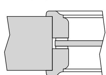
Maße gelten für gefälzte Elemente, bei stumpfen Elementen müssen seitlich und oben 13mm abgezogen werden
