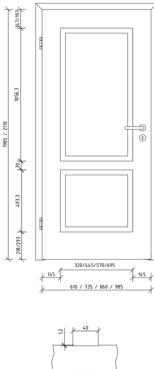
Maße gelten für gefälzte Elemente, bei stumpfen Elementen müssen seitlich und oben 13mm abgezogen werden
